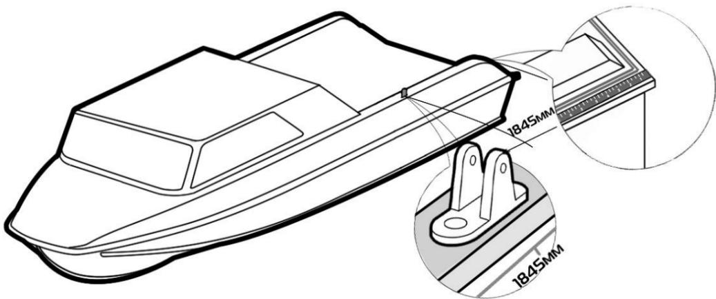
1. Установите кронштейн крепления дуг к корпусу лодки, на расстоянии 1845 мм (по центру кронштейна) от корпуса лодки со стороны кормы (см. рис). На нашем сайте, в разделе «инструкции» мы можете посмотреть фотографии размеров.
